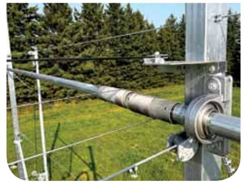
El diseño exclusivo del sistema de tracción, impulsa la cubierta del techo en la cima y el valle para garantizar un cierre óptimo de la cubierta del techo. (Solicitud de patente de los Estados Unidos N.º 18/446.297, WO 2024/031185).
