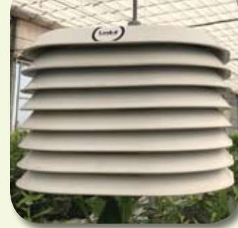
Cada cultivo debería tener su propia zona de riego, un sensor de temperatura y humedad relativa interior, para permitir un control óptimo del techo y del sistema de nebulización.
